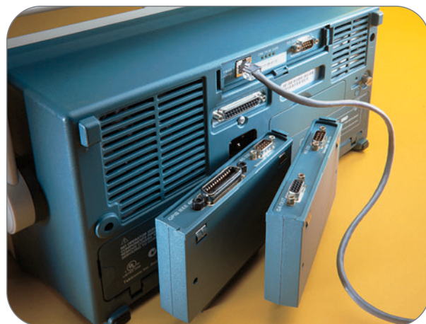
► Abbildung 55. Ein Oszilloskop der TDS3000-Serie bietet ein breites Angebot an Datenübertragungsschnittstellen, wie einen standardmäßigen Centronics-Anschluss und optionale Ethernet/RS-232-, GPIB/RS-232- und VGA/RS-232-Module
