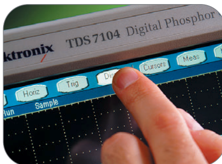
► Abbildung 61. Berührungssensitiver Bildschirm löst Probleme überladener Labortische und -wagen und bietet gleichzeitig Zugriff auf eindeutige Bildschirmtasten
