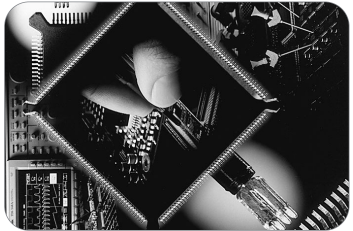
► Abbildung 45. Die Tektronix SureFoot™-Adapter der SF200A- und SF500-Serie liefern zuverlässigen und direkten Tastkopfkontakt an einem bestimmten Stift einer integrierten Schaltung ohne lange Anschlussleitungen
