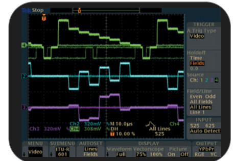
► Abbildung 58. Das Videomodul TDS3SDI macht das Oszilloskop der TDS3000-Serie zu einem schnellen, vielseitigen Gerät für die Video-Fehlersuche
